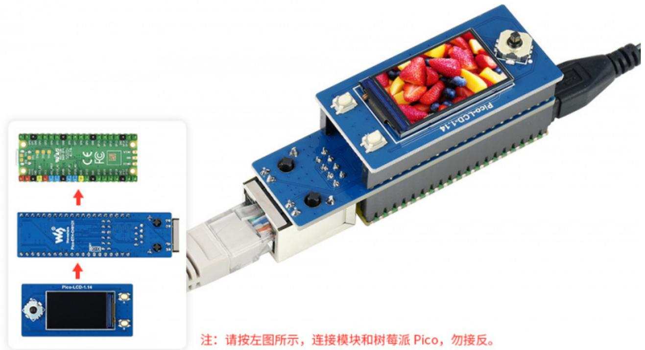
如需使用屏幕，请将Pico-ETH-CH9121上的CFG0短路帽拔掉。
