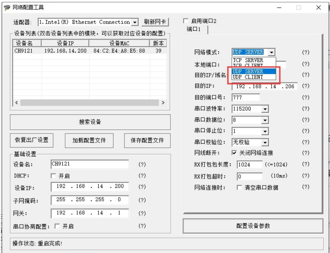
2、通过SSCOM去连接配置成UDP CLIENT/Servre的模块 (SSCOM的UDP模式会自动连接, 不管你的模式配置成CLIENT/Servre) , 连接起来会如下图显示:
